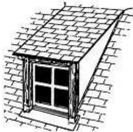
lucarne rampante ou en chien couché
